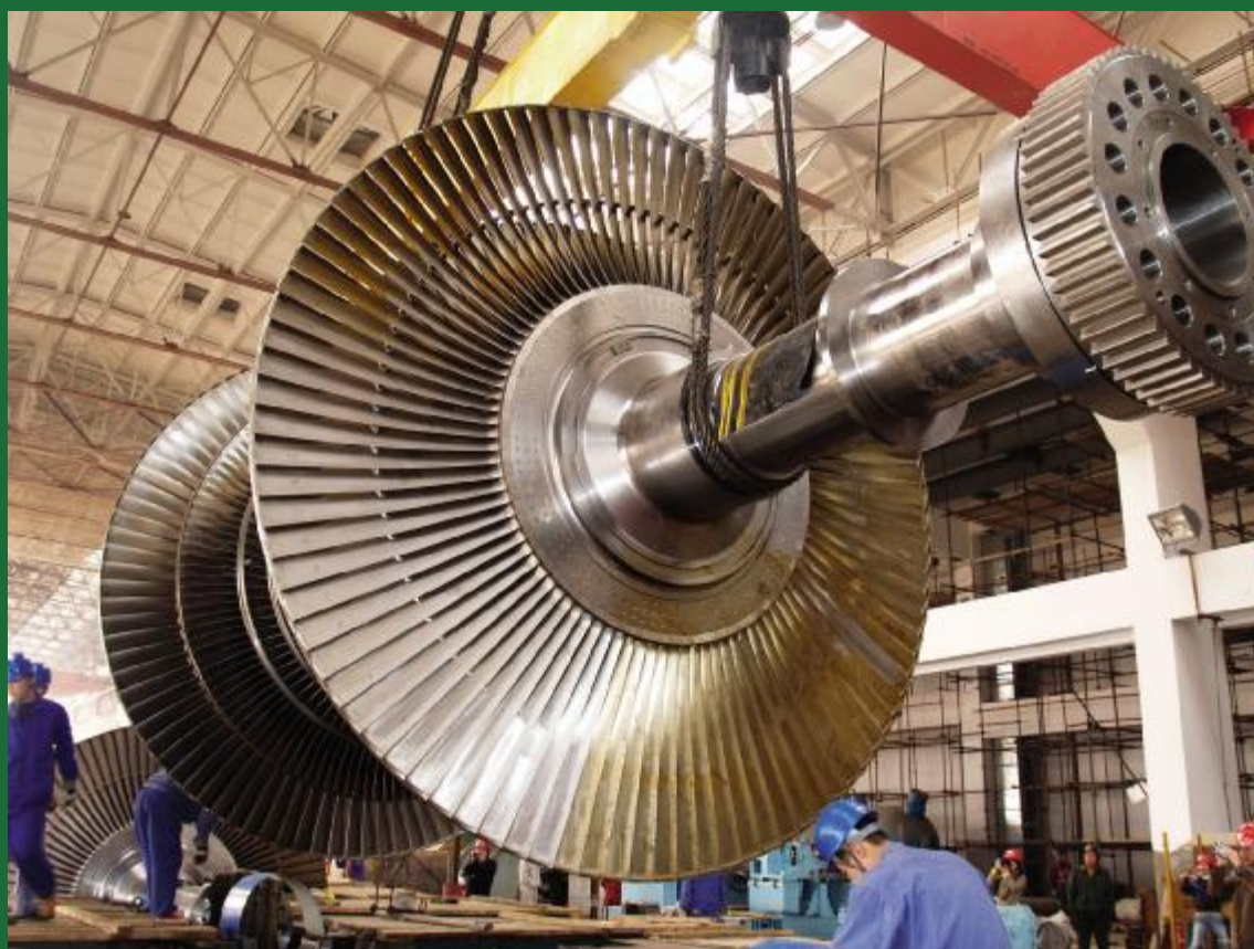
① 汽轮机转子吊装 ② 一号发电机组
