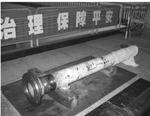
修复后的外操作油管
