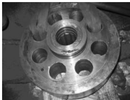
桨叶窜油处理(活塞杆压盖)
